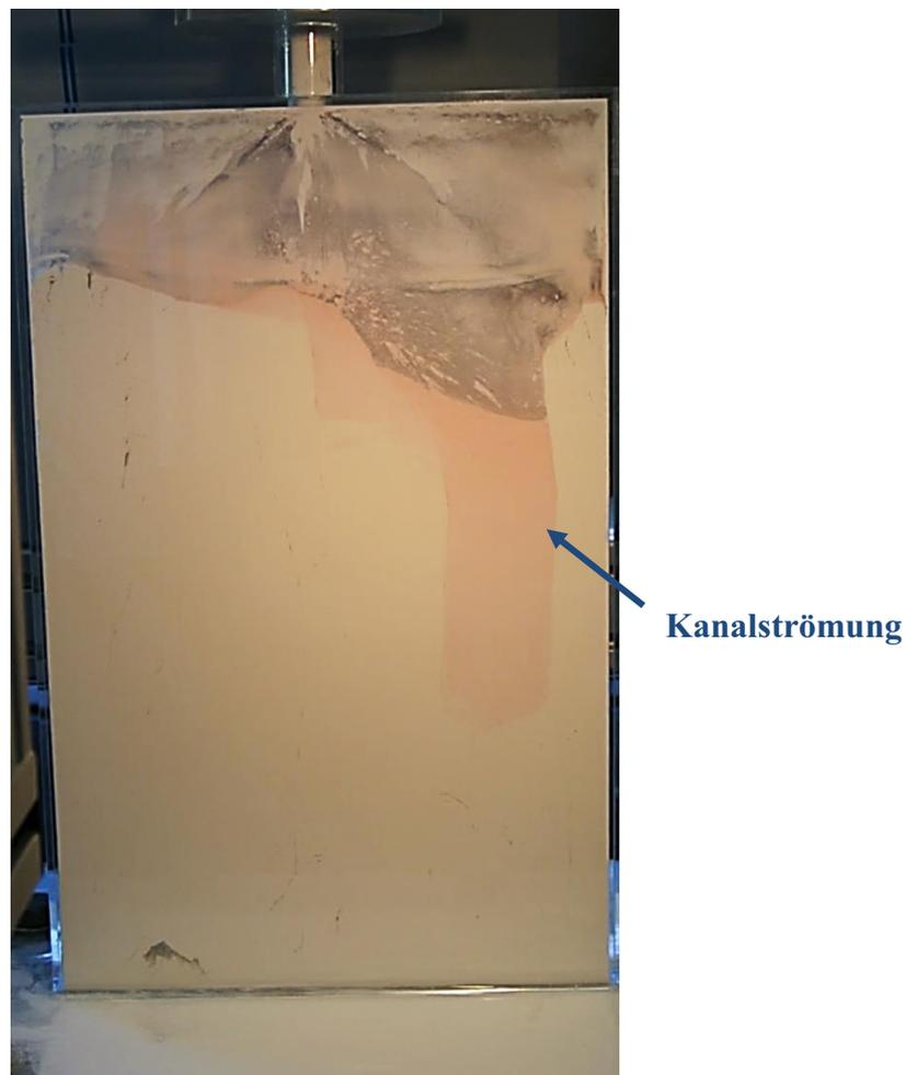
Abbildung 5-5: Versuchsergebnis bei unveränderter Fördereinheit (Mischpaddel aktiv, Reaktor parallel)
