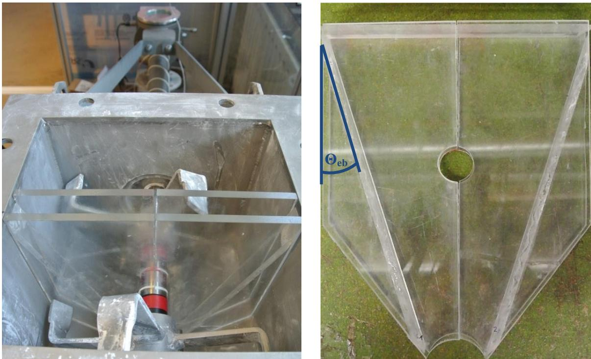
Abbildung 5-7: Verjüngender Einbau im Schneckentrog mit Minimalneigung ( $\Theta_{\text{eb}} = 17^\circ$ )
