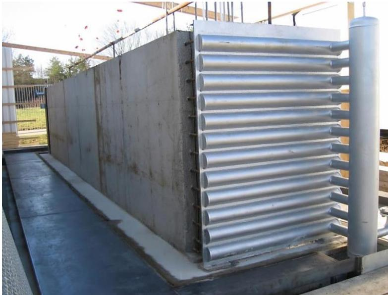
Abbildung 2-3: 20 m<sup>3</sup> - Testmodul eines Hochtemperatur-Betonwärmespeichers mit eingegossenem Rohrregister ohne Wärmedämmung (Abmessung: L 8,37 m x B 1,30 m x H 1,70 m) [8]
