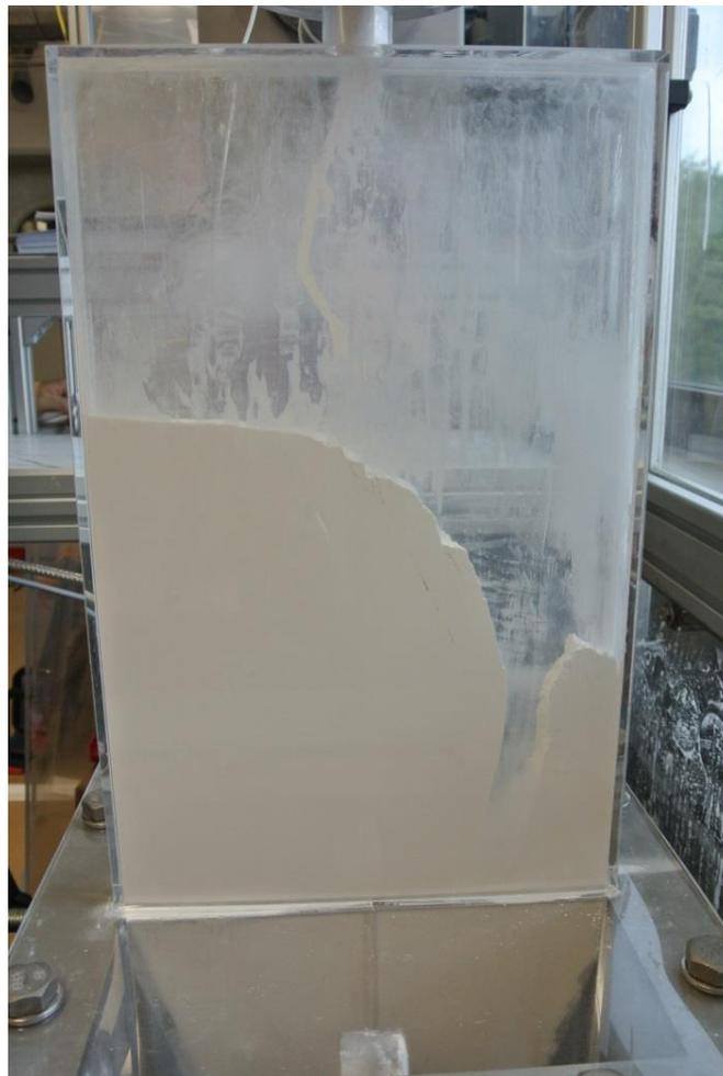
Abbildung 5-8: Versuchsergebnis mit verjüngendem Einbau (Mischpaddel inaktiv, Reaktor orthogonal)
