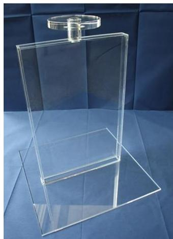
Abbildung 5-1: Fotografie des transparenten Modellreaktors für Fließversuche
