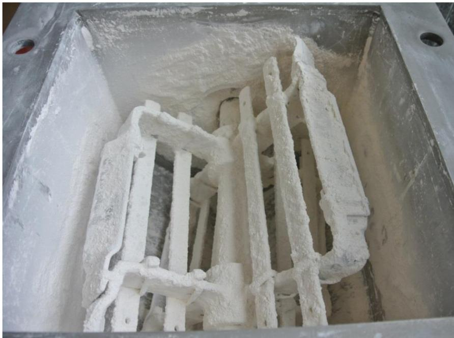
Abbildung 5-9: Modifizierung der Rührwerke durch zusätzliche Einbauten
