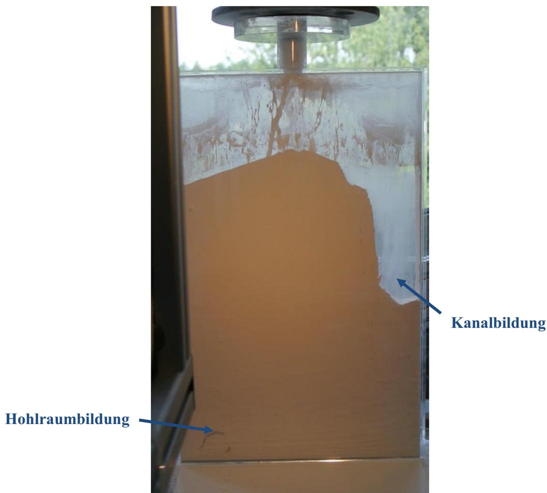
Abbildung 5-10: Versuchsergebnis mit modifizierten Mischpaddeln (Mischpaddel aktiv, Reaktor parallel)
