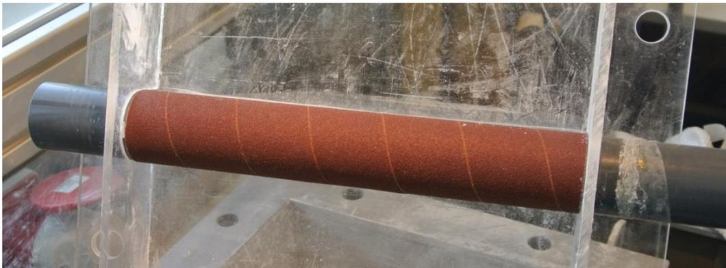
Abbildung 6-3: Anordnung einer glatten Welle mit erhöhter Oberflächenrauigkeit unter dem Reaktorspalt
