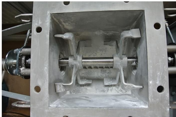
Abbildung 4-7: Schneckenrotor der abführenden Feindosiereinheit mit Auflockerungspaddeln
