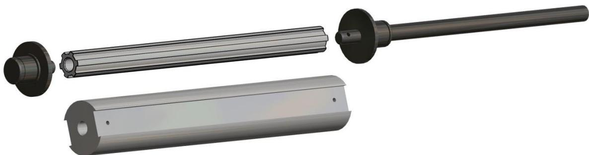
Abbildung 6-7: Explosionsdarstellung der dreiteiligen Zahnwelle mit optionaler Kammerwelle
