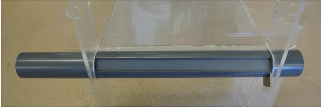
Abbildung 6-4: Positionierung einer zweizelligen Kammerwelle unter dem Reaktorspalt
