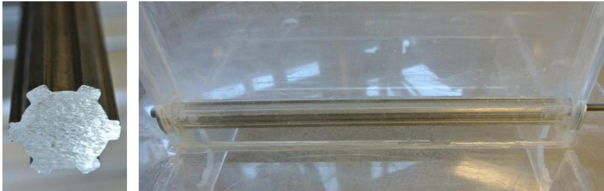
Abbildung 6-5: Querschnitt und Einbaulage der sechszelligen Zahnwelle im Reaktorspalt
