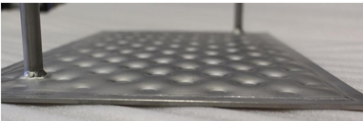
Abbildung 4-4: Fotografie einer Stegplatte mit Kissenstruktur und WTF-Anschlüssen
