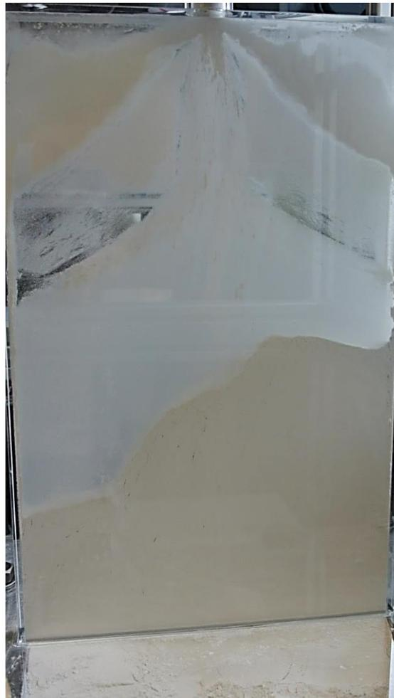
Abbildung 5-3: Versuchsergebnis bei unveränderter Fördereinheit (Mischpaddel aktiv, Reaktor orthogonal)
