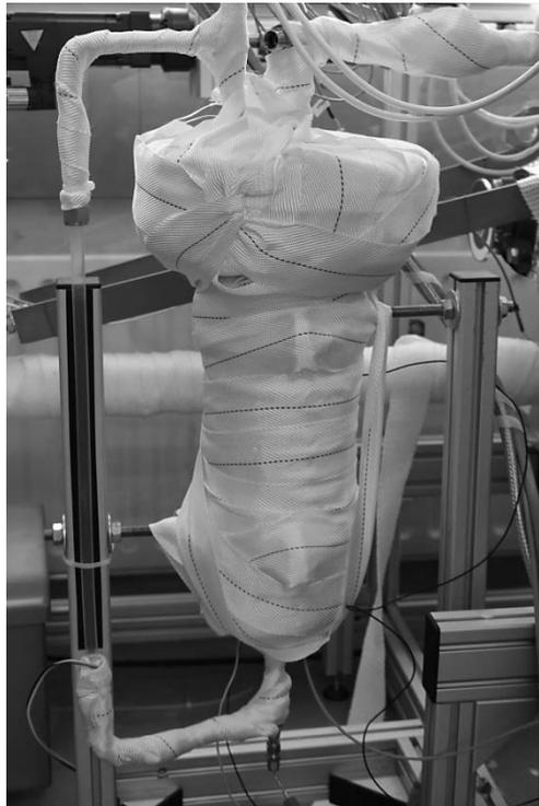
Abbildung 4-10: Druckhalter mit Füllstandanzeiger, Isolierung und Regeltechnik
